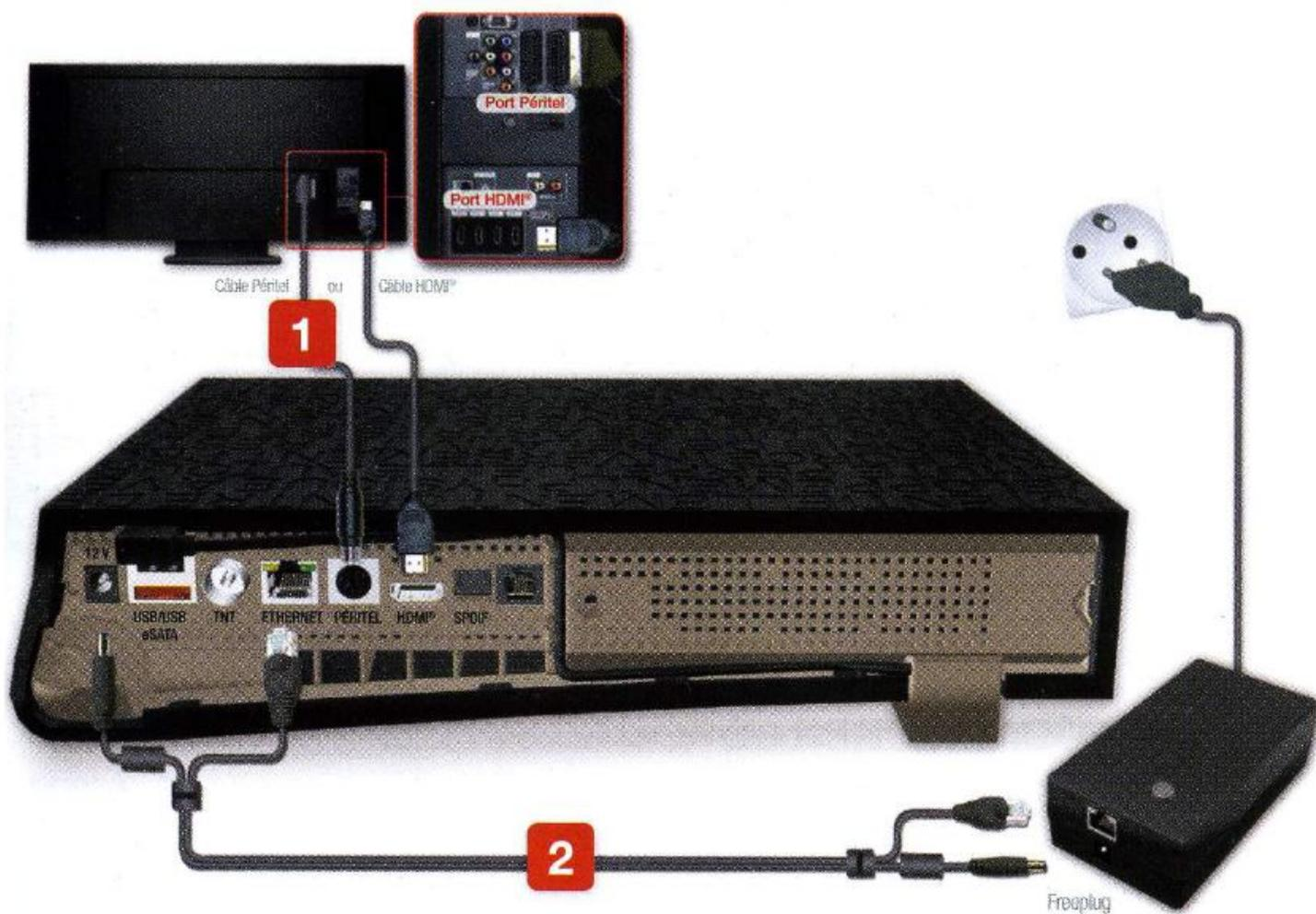
**1** Reliez le Freebox Player à votre téléviseur HD grâce au câble HDMI fourni. Si votre téléviseur ne dispose pas d'entrée HDMI, utilisez le câble PÉritel fourni. Allumez le téléviseur à l'aide de sa télécommande et, afin de basculer sur l'entrée sur laquelle le Freebox Player est relié, appuyez sur le bouton « Source » pour choisir HDMI, AV-1, EXT-1, AUX, etc., selon le modèle de téléviseur.
